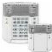
Tastiera con indicatori LED 32 zone e sportello verticale di protezione dei tasti, indicatori LED separati per la visualizzazione dello stato d'inserimento Totale, Notturmo, Perimetrale e Disinserito di ciascuna delle 2 aree. 8 tasti di attivazione rapida, 3 tasti di attivazione allarme. Possibilità di regolazione della luminosità. Collegamento su BUS (max. 15 tastiere). 1 ingresso di zona.
