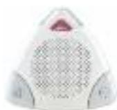
Unità vocale per centrali DIGIPLEX EVO. Collegare al modulo LSN4 tramite cavo CAT-5. 3 tasti: uno per chiamata (per comunicare con la Centrale di Sorveglianza e/o con altre unità vocali, come interfono), uno per emergenza (invia una chiamata di emergenza), uno "mute" (interrompe la riproduzione dei messaggi audio e/o della musica). Microfono ad alta sensibilità incorporato, possibilità di regolazione indipendente del volume. Dimensioni mm 125x120x40.
