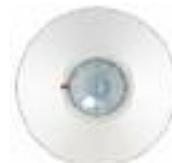
**Rivelatore PIR** da soffitto con due sensori a doppio elemento affiancati, per analisi della direzione del movimento. Possibilità di muoversi in una direzione e poi ritornare nella direzione opposta entro un tempo selezionabile, senza generare un allarme. Portata m 0.67xm 4.8 e m 0.60xm 4.8 ad un'altezza di installazione di m 2.4.
