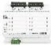
Modulo espansione 8 zone cablate. Collegamento diretto sul BUS della centrale. Fornito in contenitore standard DIN per una rapida e conveniente installazione con morsettiera estraibile per una manutenzione veloce. Dimensioni mm 106 x 104.
